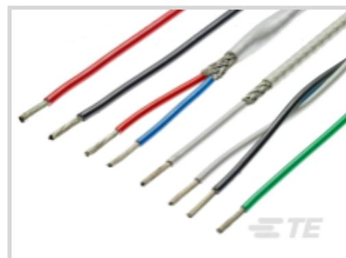
Type de câble: **Spec 44**Tension de fonctionnement: **600 V**Matériau de l'isolant: **PVDF modifié réticulé par rayonnement**Matériau du conducteur: **Cuivre revêtu d'étain**Dimension du fil: **24 AWG**
