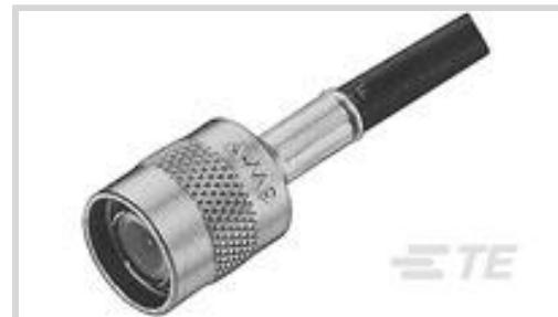
Interfaz de RF: **TNC**Estilo de conector RF: **Conector macho**Diámetro externo del conector RF acoplado (aproximado): **16.26 mm [ .64 in ]**Impedancia: **50 Ω**Compatible con el tipo de cable RF: **RG 174, RG 174A, RG 188, RG 188A, RG 316**
