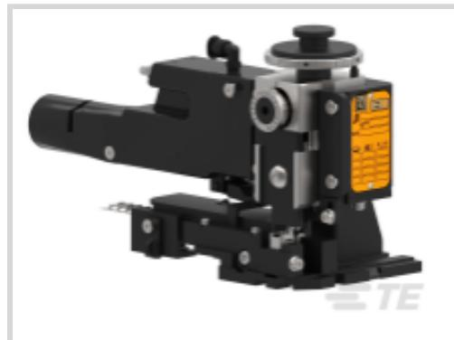
Tipo de alimentación del aplicador: **Neumático**Estilo de aplicador y de producto: **OCEAN**Interfaz de aplicación: **Poste adaptador macho – Estilo atlántico**Tipo de remachadora: **Sello de pelacables/engarzadoras (Komax o Schleuniger)**Ancho del remache del cable: **2.29 mm [.09 in]**
