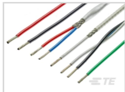
Rango de temperatura de funcionamiento: **'-65 – 150 °C [ -85 – 302 °F ]'**Tipo de cable: [Especificaciones 44](#)Voltaje de funcionamiento: **600 VAC**Material de aislamiento para alambres y cables: **PVDF reticulado por radiación y modificado**Material del conductor: **Cobre recubierto en estaño**
