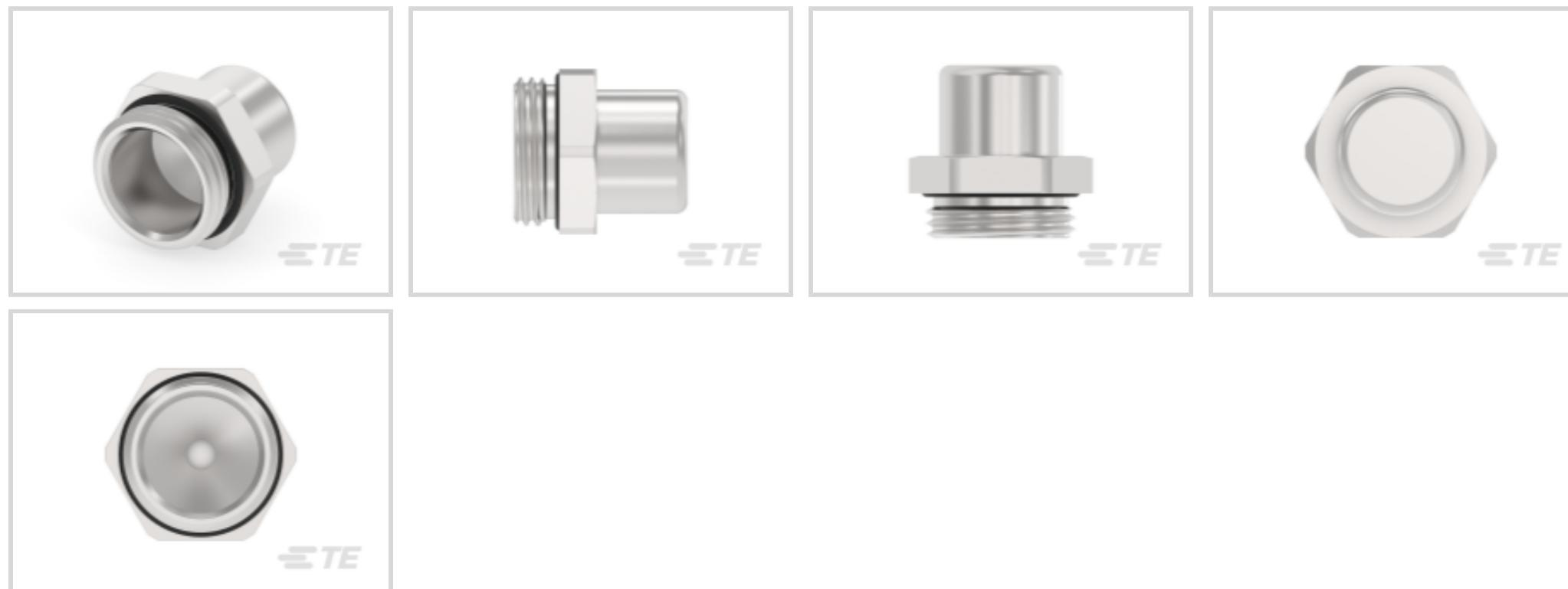
Kabelverschraubung – Produkttyp: **Beatmungsstecker**Primärproduktmaterial: **Edelstahl**Außengewindegröße: **M20 x 1.5**Abdichtbar: **Ja**IP-Schutzzart: **IP68**[Alle Metal Ventilation Plug \(32\)](#)
