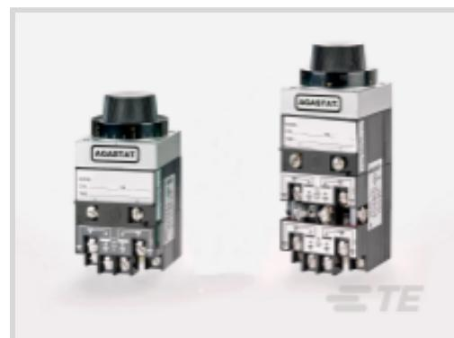
Relais-/Schütztyp: **Zeitverzögerungsrelais**Kontaktanordnung: **2 Form C DPDT-CO**Stromform: **AC**Kontaktnennstrom: **1 A, 10 A**Hauptleitungs-/Verbindungstyp: **Schraubanschlüsse**
