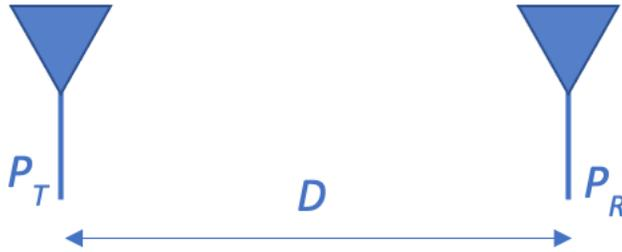
图 1：发射和接收天线之间的无线通信链路
