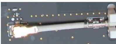
图9：电缆在PCB上的接地
