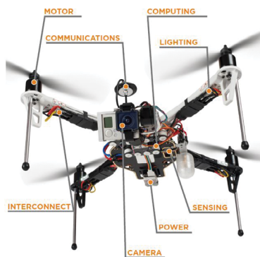
商用ドローンのサブシステム。
