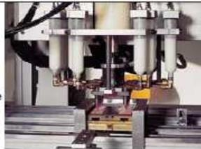
Durch aufsetzen der Kappe und abdichten der Relais wird die Montage abgeschlossen.
