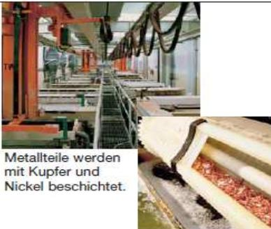
Metallteile werden mit Kupfer und Nickel beschichtet.
