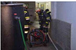
Ein Ventilator zur Lüftung des Raumes wird in Position gebracht.
