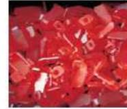
Die Stahlteile werden zur Verbesserung der magnetischen Eigenschaften bei ca. 820°C in Schutzgasatmosphäre geblüht.
