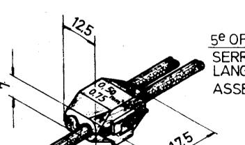
5º OPERATION: SERRER JUSQU'À CE QUE LA LANGUETTE SOITVERROUILLÉE. ASSEMBLAGE TERMINÉ.
