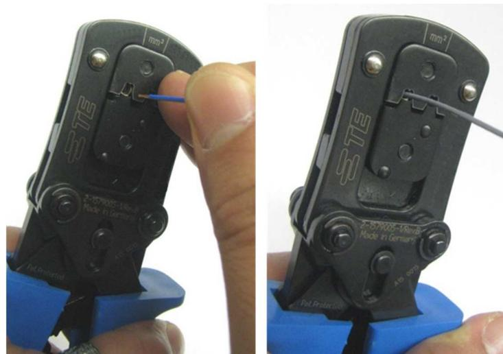
Abbildung 4: Leitung in den Crimpbereich einführen (links), Handzange schließen (rechts)
