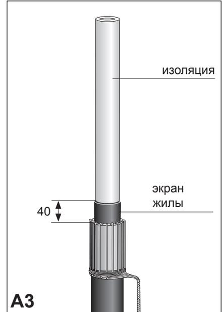
С поверхности изоляции тщательно удалить полупроводящий экран, не доходя 40 мм до среза наружного покрова.
