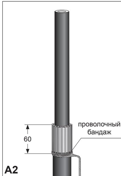
Отогнуть все проволоки экрана на наружный покров и разложить их равномерно, избегая перехлестывания.
