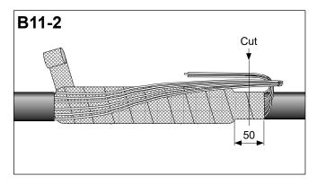
Connecter les 2 écrans à l'aide du petit raccord mécanique pour l'écran fourni dans le kit.
