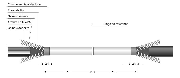
Enlever la gaine intérieure selon la dimension **c** (voir **tableau 3**). Replier les fils de l'écran sur la gaine extérieure et les fixer temporairement avec de la bande auto-collante. Bien recouvrir les pointes aigües. Scier les câbles sur la ligne de référence.
