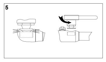
Nettoyer et dégraisser les câbles et le raccord.
