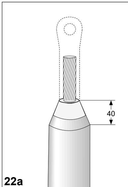
Couper à nouveau le tube sur l'isolation. Chanfreiner l'isolation au diamètre de la cosse pour réaliser une transition en douceur.
