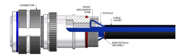
11. MOVE REAR GROUNDING CONE FORWARD TO TRAP PIGTAILS AGAINST THE FRONT CONE:
