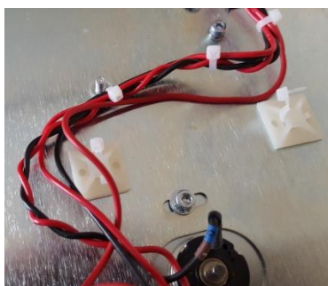
Fig. 73 Fascette dei cavi sul condensatore
