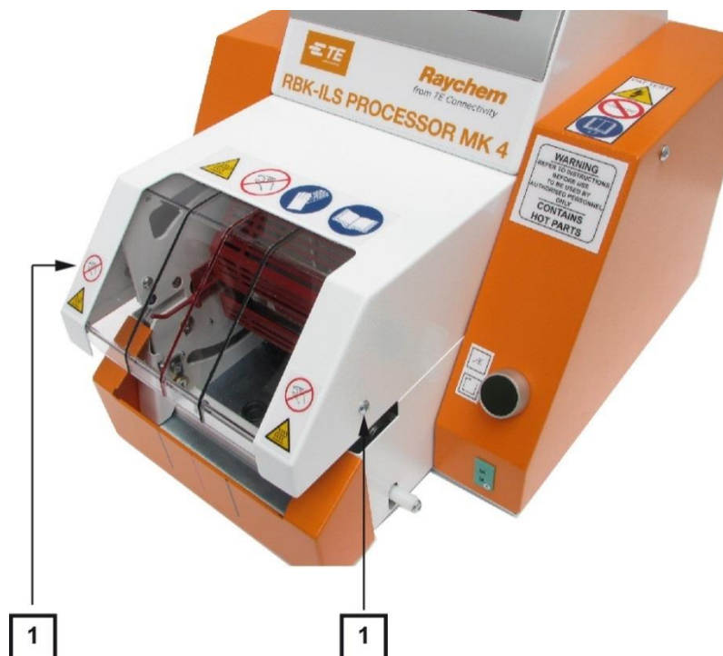
Fig. 46 Parete di riscaldamento, in alto
