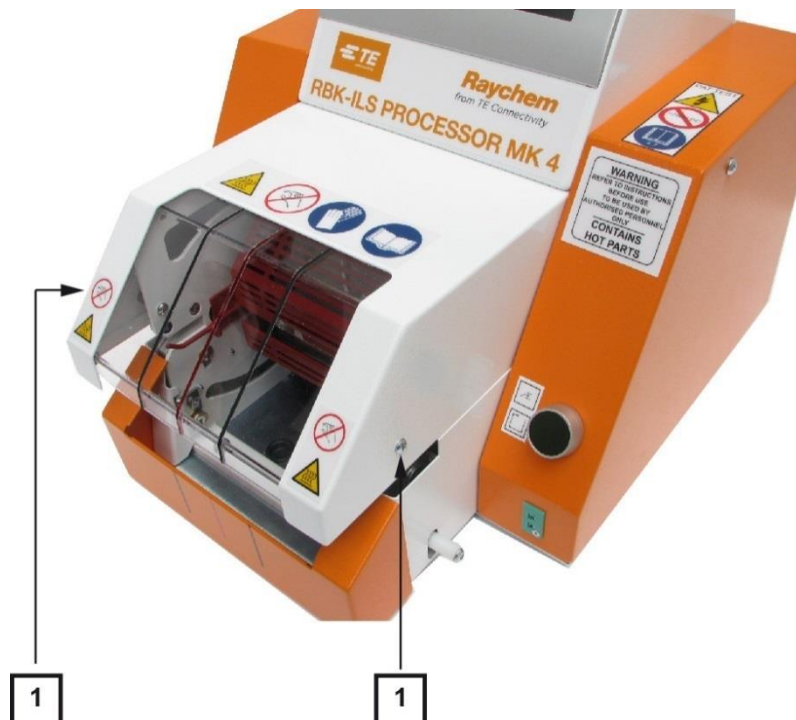
Abb. 47 : Viršutinė šildymo sienelė
