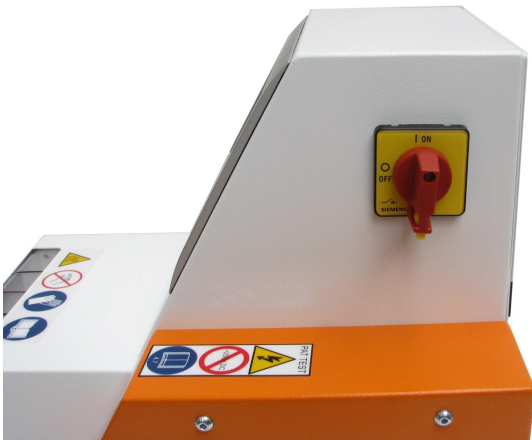
Abb. 1 : Pagrindinis jungiklis su avarinio išjungimo funkcija
