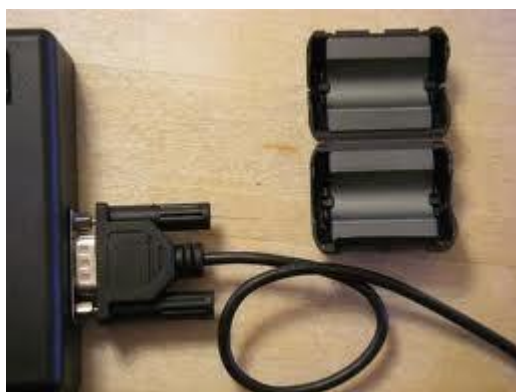
Abb. 93 : Kabelio kilpa prie feritinės šerdies
