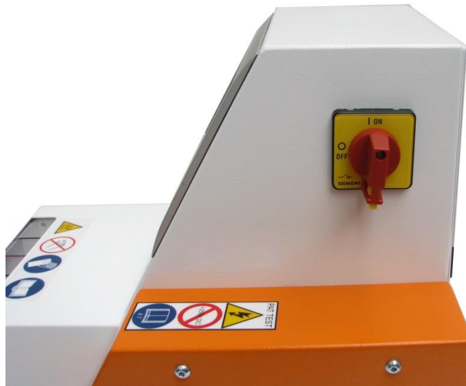
Abb. 6 : Pagrindinis jungiklis su avarinio išjungimo funkcija
