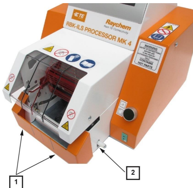
Abb. 46 : Šildymo pusių sienelė apačioje ir priekinis skydas
