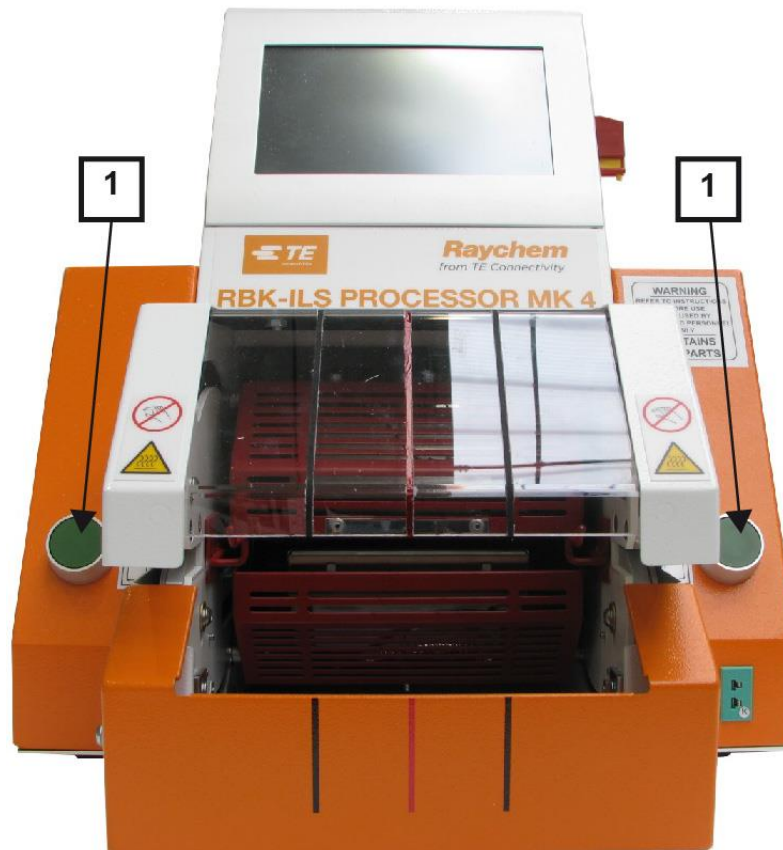
Abb. 2 : Aktyvavimo abiem rankomis sistema
