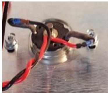
Abb. 74 : Przyłącza elektryczne silnika
