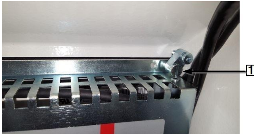
Abb. 87 : Vis de serrage de l'écran tactile
