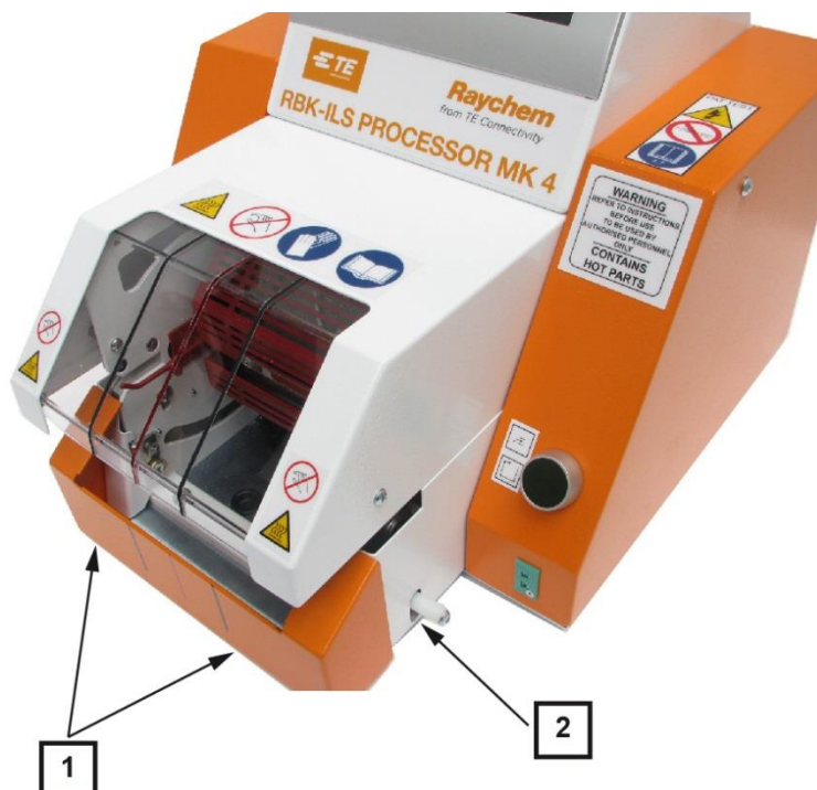
Abb. 45 : Paroi latérale inférieure du chauffage et panneau avant
