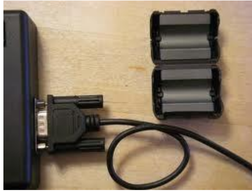
Abb. 92 : Boucle de câble sur le noyau de ferrite
