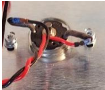
Abb. 74 : Branchements électriques du moteur
