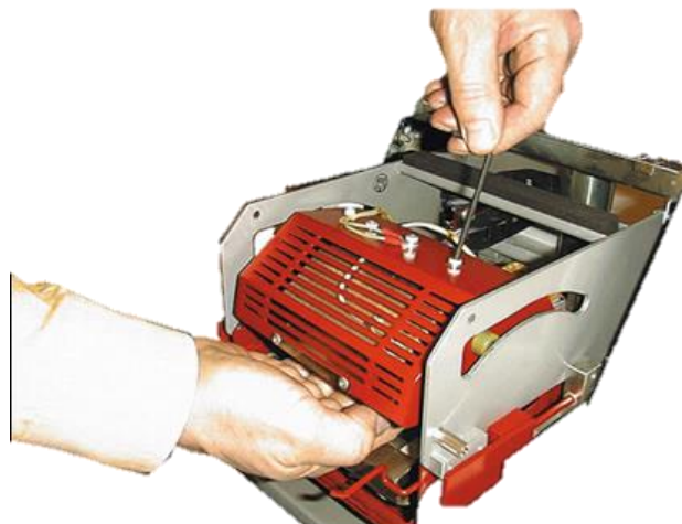
Abb. 63 : Retrait du chauffage
