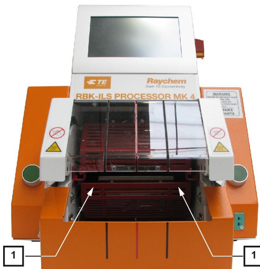
Abb. 39 : Ruční přemístění dolní topné komory
