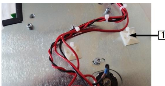
Abb. 49 : Stahovací pásek kabelů u procesoru
