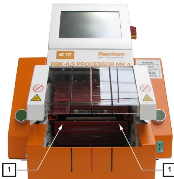
Abb. 36 : Ruční přemístění dolní topné komory
