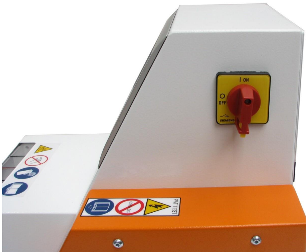
Abb. 1 : Hlavní vypínač s funkcí nouzového vypnutí
