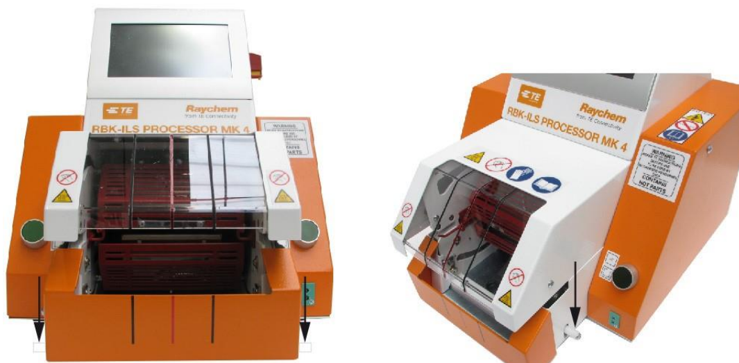
Abb. 37 : Ruční uvolnění kabelového svazku
