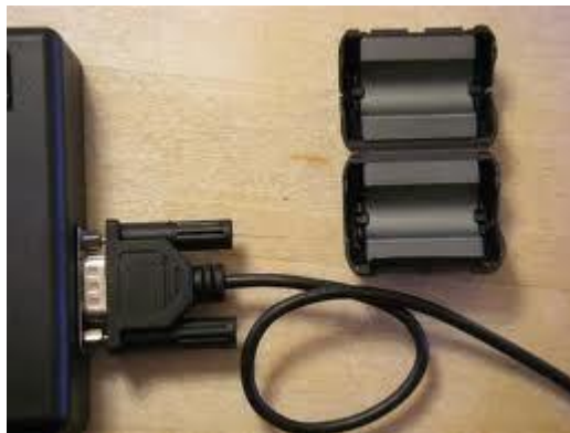
Abb. 92 : Kábelhurok a vasmagnál
