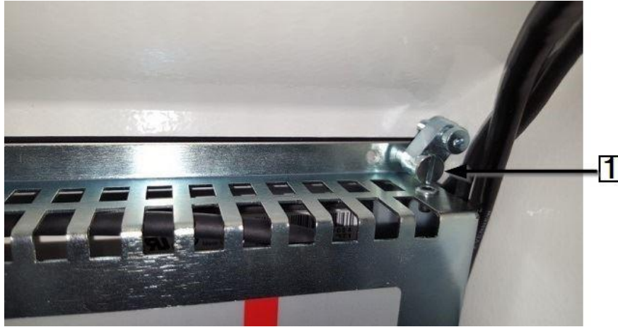
Abb. 87 : Szorítócsavar az érintőképernyőnél
