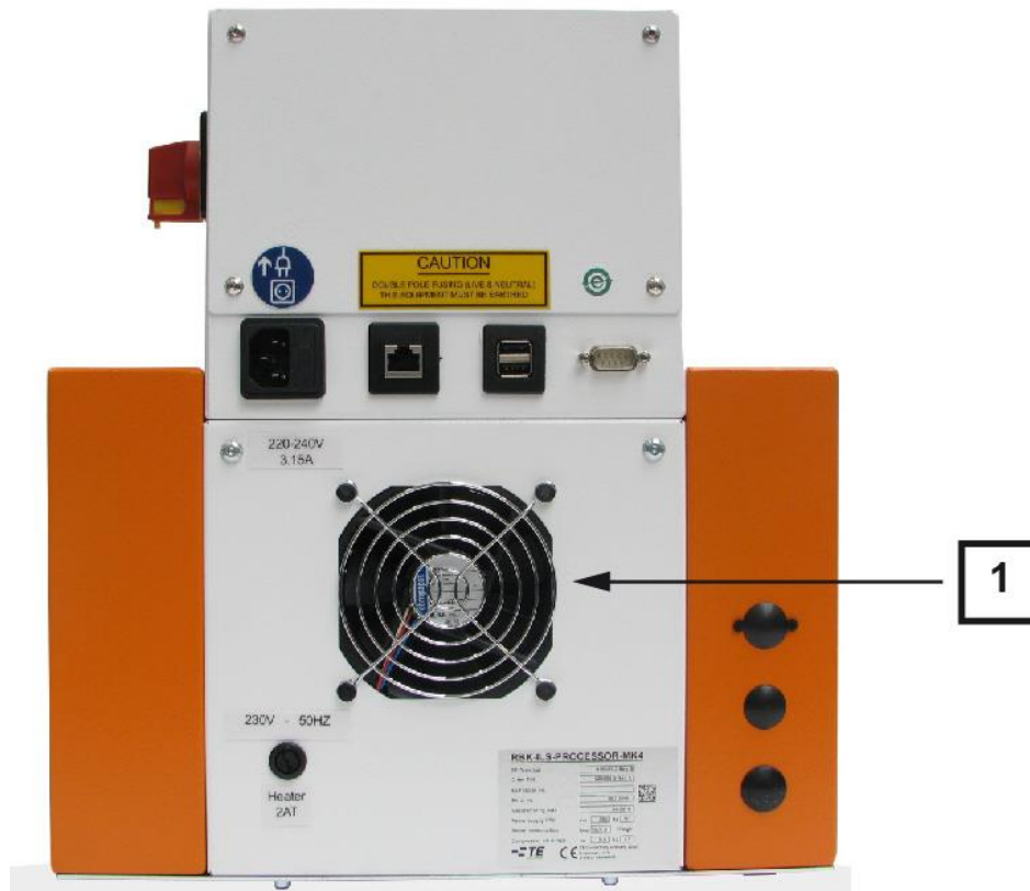
Abb. 57 : Ventilator de răcire
