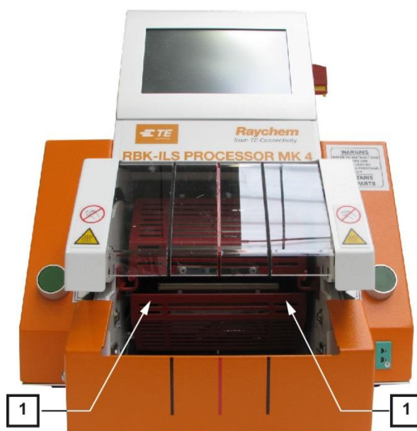
Abb. 36 : Deplasarea manuală a camerei de încălzire de jos
