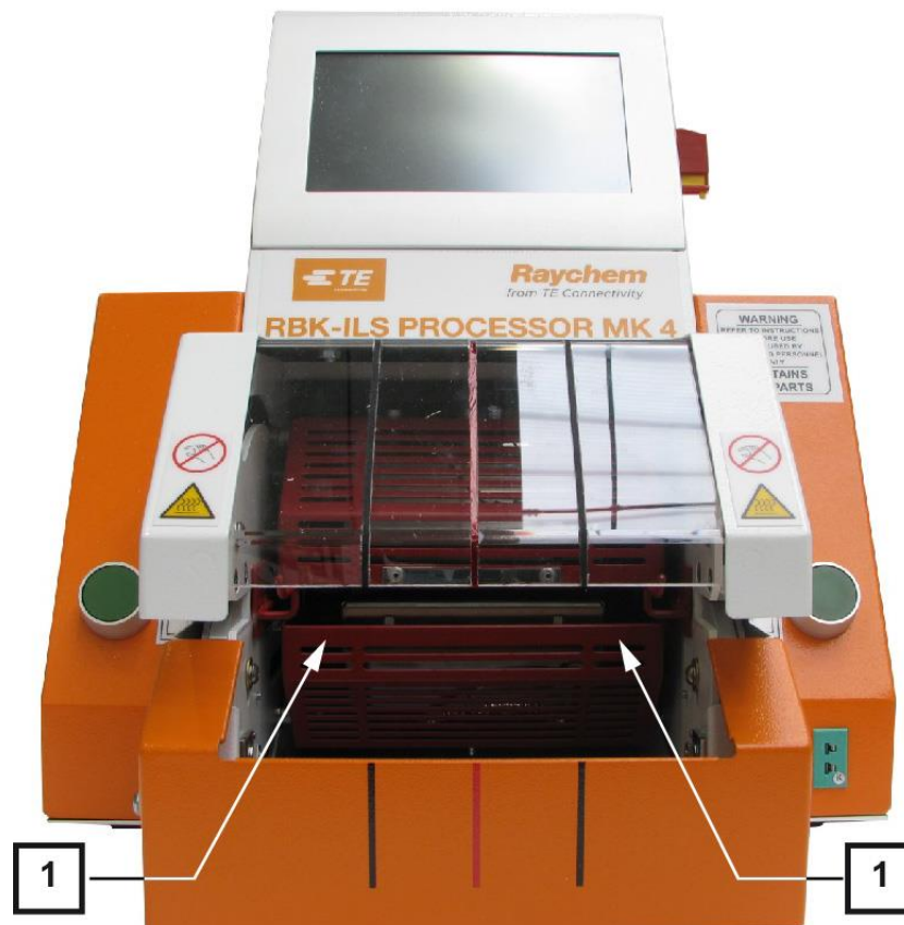
Abb. 39 : Deplasarea manuală a camerei de încălzire de jos
