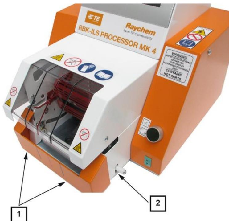
Fig. 52 : Paredes laterales del calentador inferior y panel delantero
