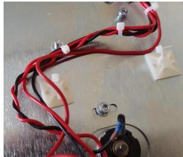
Fig. 80 : Abrazaderas del condensador
