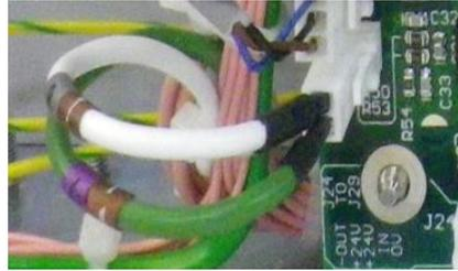
Fig. 92 : Cable de compensación del termopar en el controlador de la PCB
