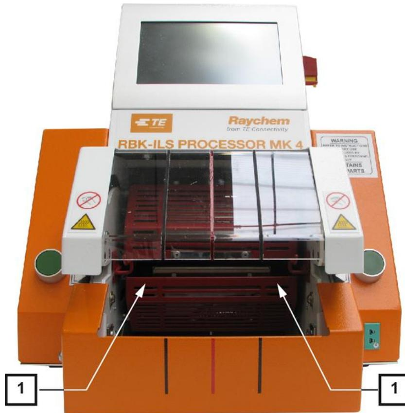
Fig. 47 : Desplazamiento manual de la cámara de calentamiento inferior
