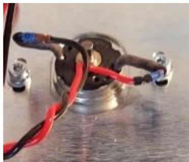
Fig. 81 : Conexiones eléctricas del motor
