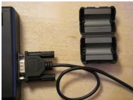
Fig. 101 : Bucle en el cable en el núcleo de ferrita
