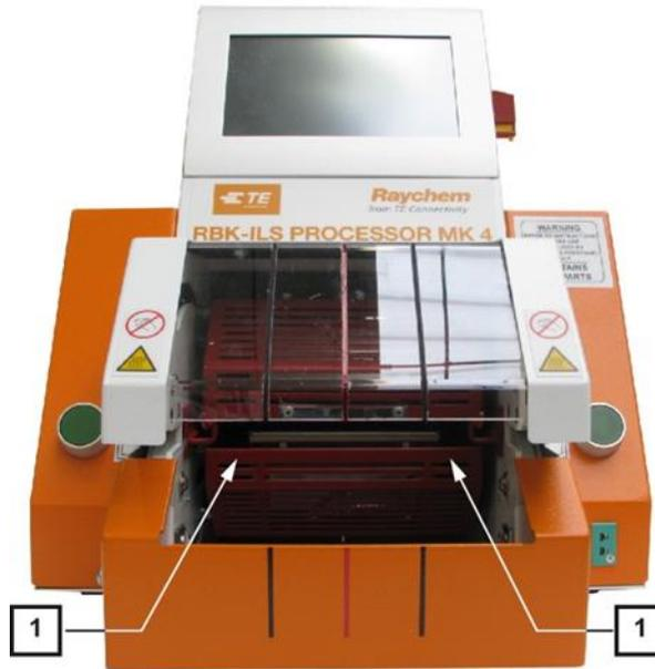
Fig. 44 : Desplazamiento manual de la cámara de calentamiento inferior
