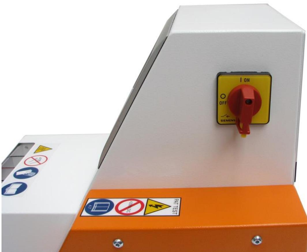
Fig. 1 : Interruptor principal con función de parada de emergencia
