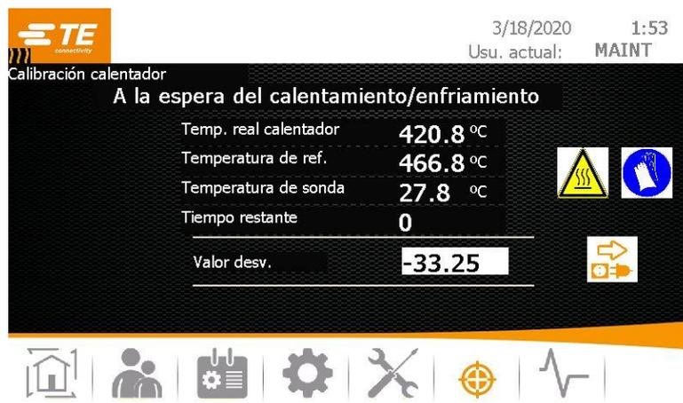
Fig. 40 : Pantalla **A la espera del calentamiento/enfriamiento**
