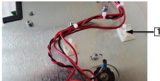
Fig. 56 : Conexión de abrazaderas del procesador
