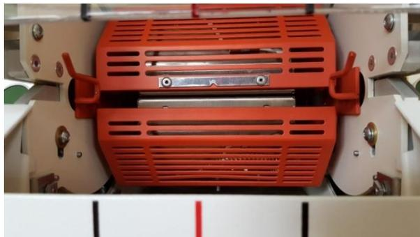
Fig. 72 : Cámara de calentamiento en su posición replegada
