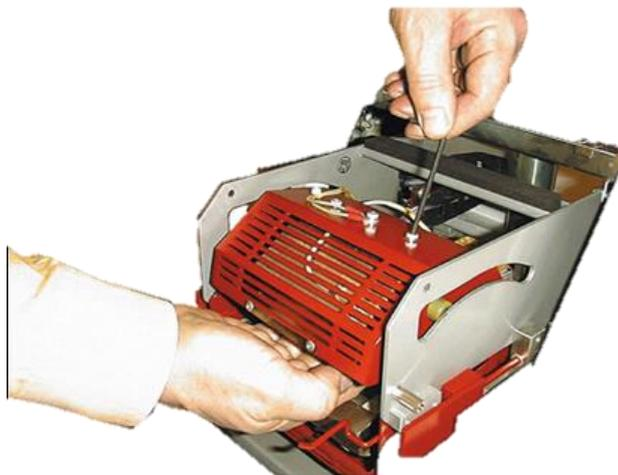
Fig. 70 : Extracción del calentador
