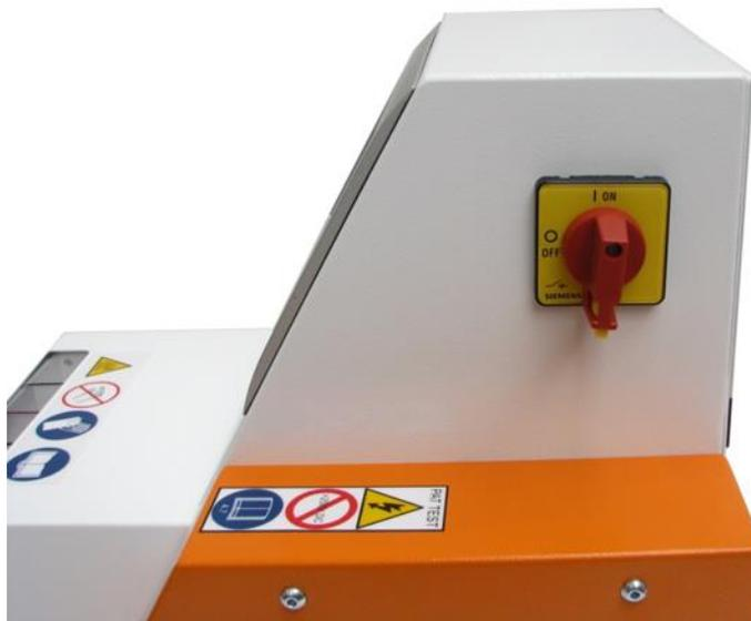
Fig. 6 : Interruptor principal con función de parada de emergencia
