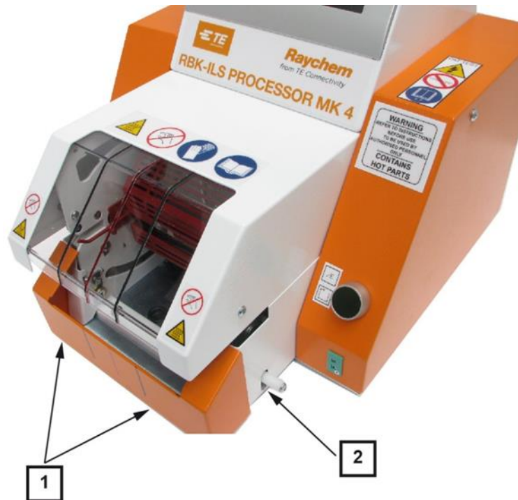
Abb 53 : Heizungsseitenwand unten und Fronttafel
