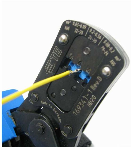
Abb. 4 : Kontakt aus der Crimpmatrize entnehmen, gecrimpten Kontakt überprüfen
