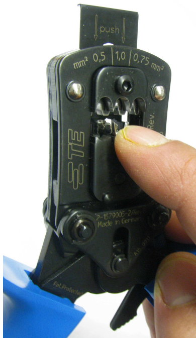
Abb. 5: Kontakt wird eingeführt
