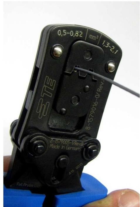
Abb. 4 : Abisolierte Leitung in den Crimpbereich bis zum Anschlag einführen (links), Handzange schließen und Crimpen (rechts).
