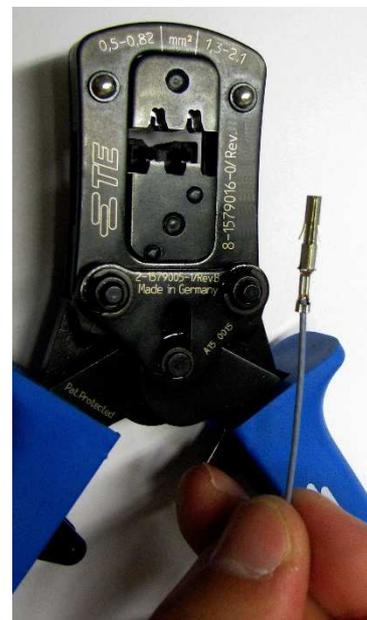
Abb. 5 : Kontakt aus der Crimpmatrize entnehmen (links), gecrimpten Kontakt überprüfen (rechts)
