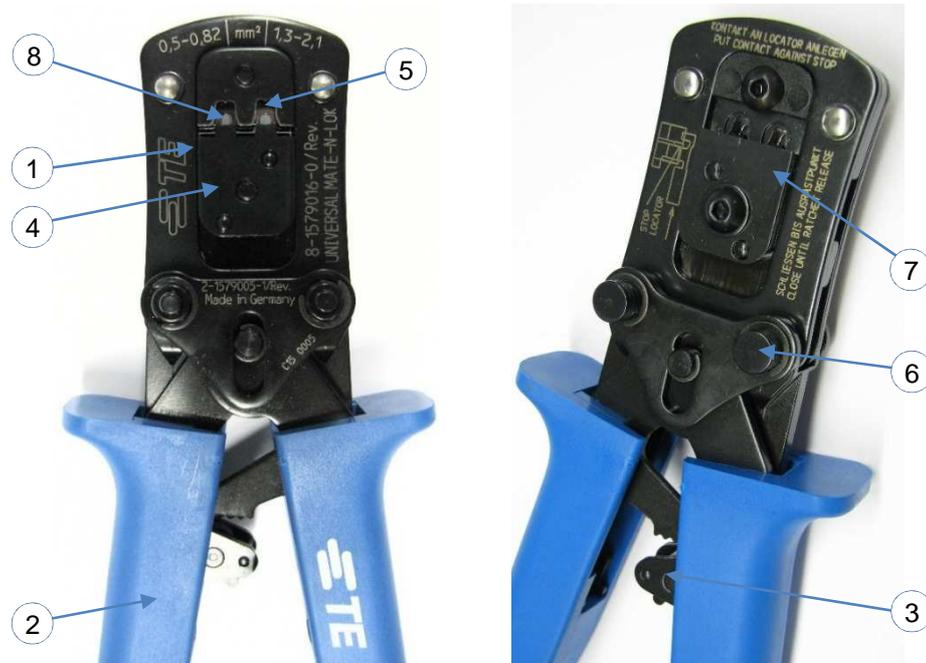
Abb. 2 : Die Handzange, Vorderseite (links), Rückseite (rechts)
