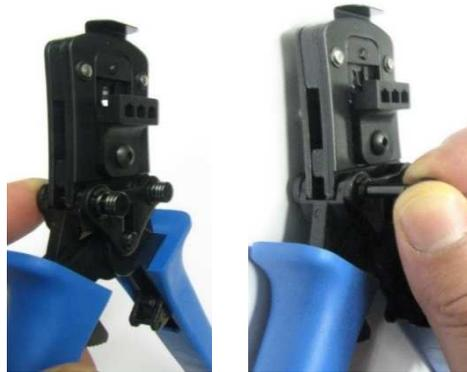
Abb. 1 : Verriegelungsbolzen ausziehen
