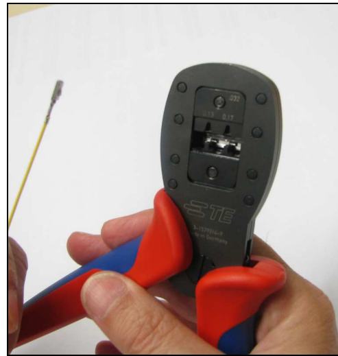
Abb. 9: Kontakt aus der Crimpmatrize entnehmen Abb. 10: Gecrimpten Kontakt überprüfen
