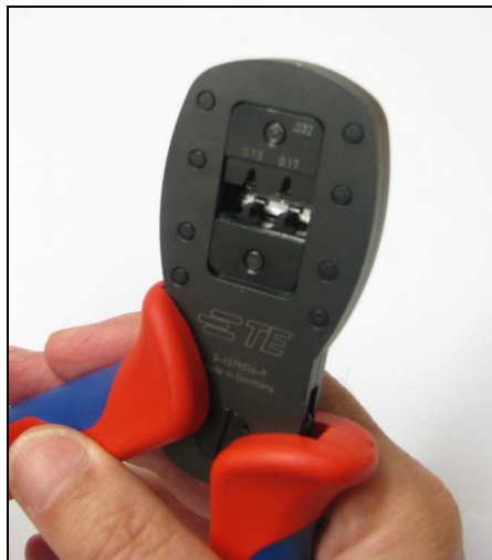
Abb. 3: Handzange völlig öffnen lassen
