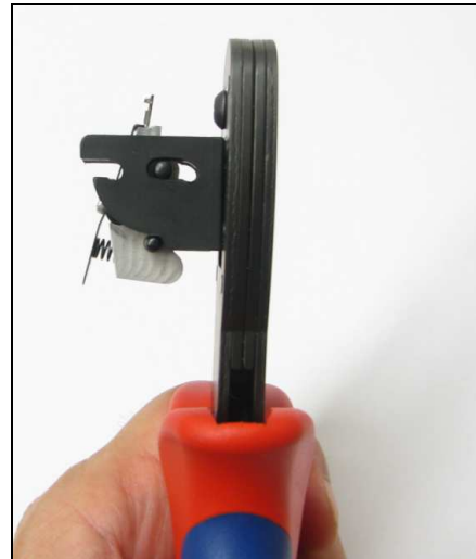
Abb. 6: Kontakt in Position sichern
