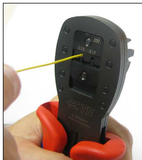
Abb. 8: Handzange schließen und Crimpen
