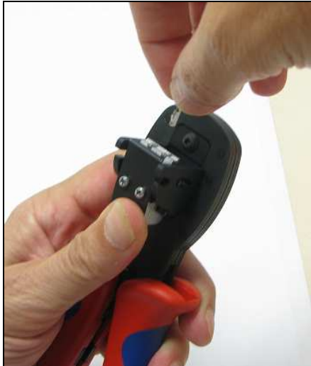
Abb. 5: Kontakt bis zum Anschlag in die Aufnahme schieben
