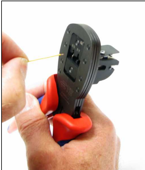
Abb. 7: Abisolierte Leitung in die Crimphülse des Kontaktes bis Drahtanschlag einlegen
