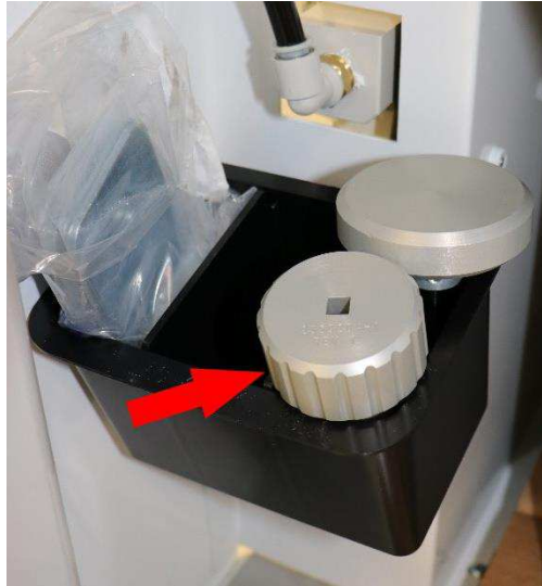
Bild 96: Dornväxlingsverktyg i verktygshållaren
