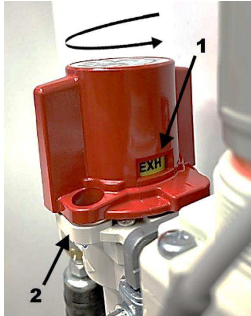
Figura 6: Válvula de desconexión neumática principal en posición EXH
