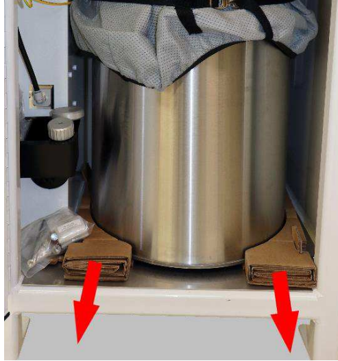
Figura 34: Retirada de los insertos de cartón corrugado
