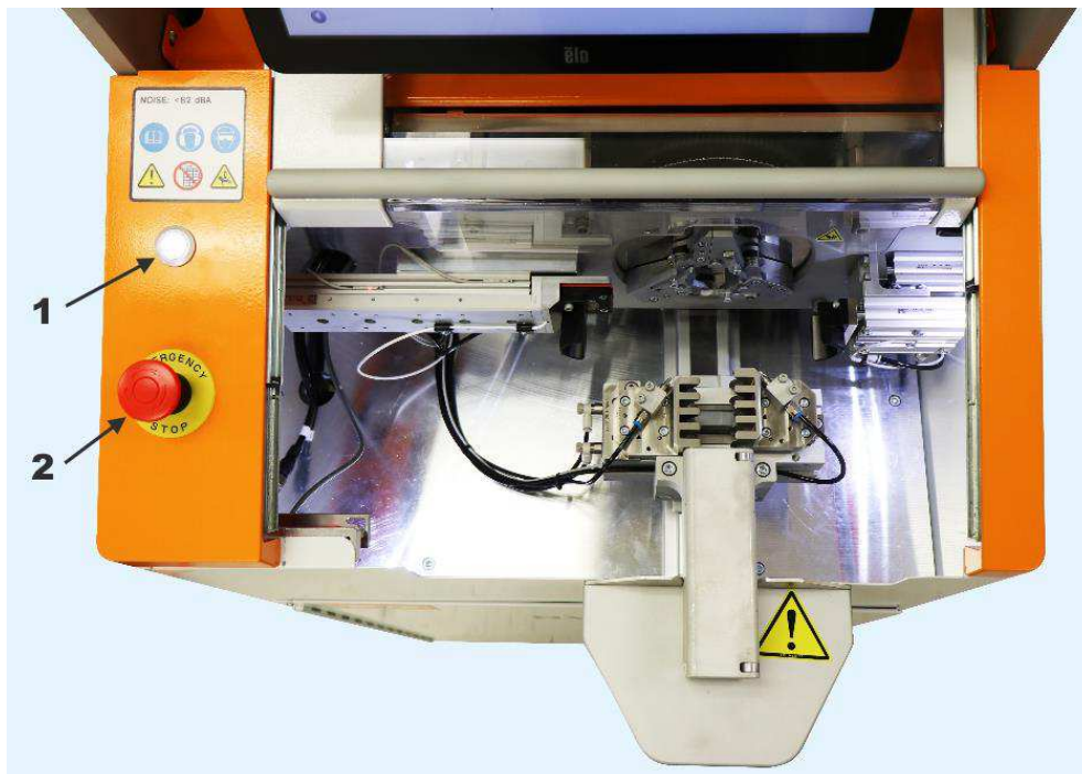
Figura 11: Controles de parada de emergencia
