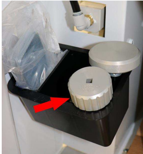
Figura 96: Herramienta para el cambio del mandril en el portaherramientas
