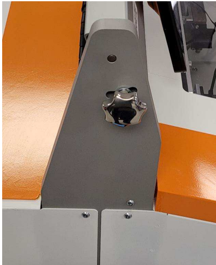
Figura 33: Reinstalación de las perillas de ajuste del monitor
