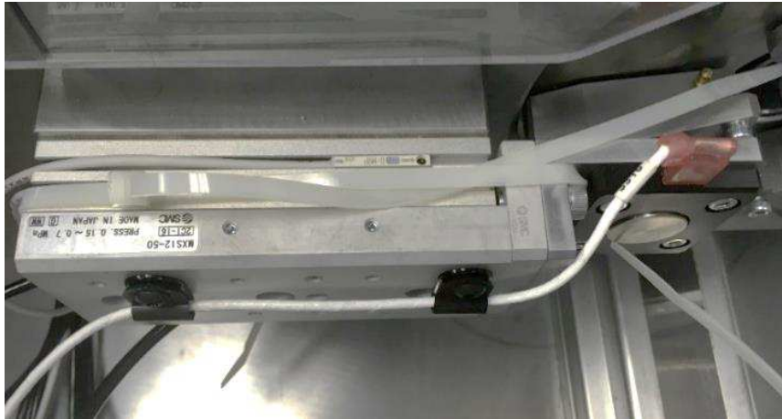
Figura 43: Cilindro de la compuerta de cable derecho
