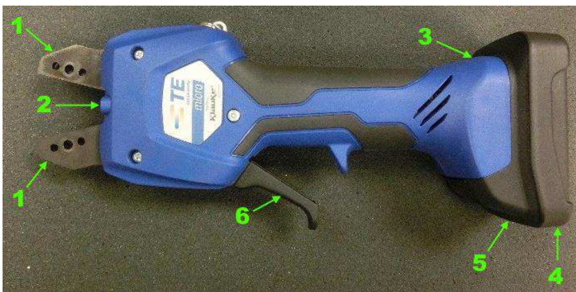
Obr. 1: Súprava krimpovacieho nástroja s nainštalovanou batériou
