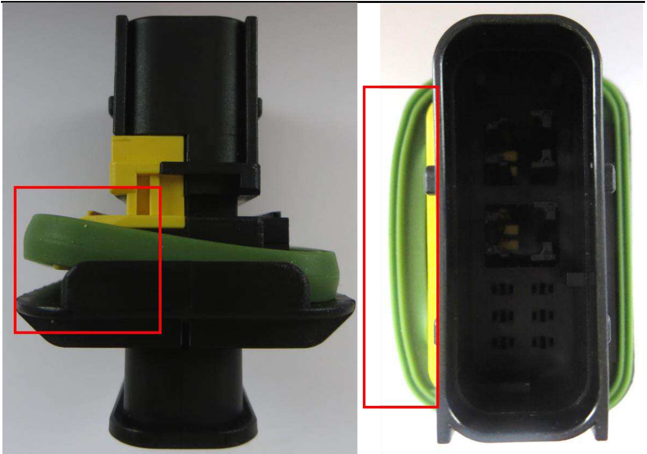
Figure / Abbildung 3.6.2.2 Axial seal slipped out of the groove / Axialdichtung aus der Nut gerutscht
