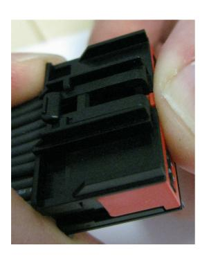
THE FRONT LOADED TPA (SPACER) IS FULLY INSERTED.
