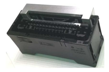
PLACE THE DEFLECTION-STOP TOOL ON THE HOUSING WALL BESIDE OF THE CONTACT CAVITIES 31-45 AS SHOWN AND PERFORM THE TERMINAL EXTRACTION OPERATION AS DESCRIBED ABOVE
