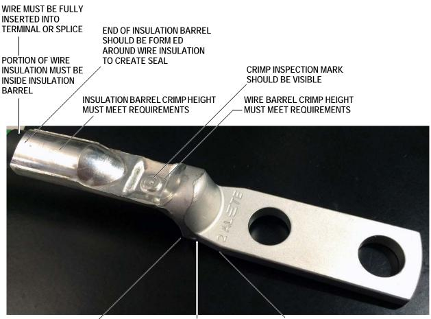
DISTANCE BETWEEN LOCATING SHOULDER AND START OF CRIMP FORMATION MUST MEET REQUIREMENT STRAIGHTNESS OF TERMINAL OR SPLICE MUST MEET REQUIREMENTS THERE SHOULD BE NO CRACKS, GOUGES, OR PEELING FINISH FOUND ON TERMINAL OR SPLICE
