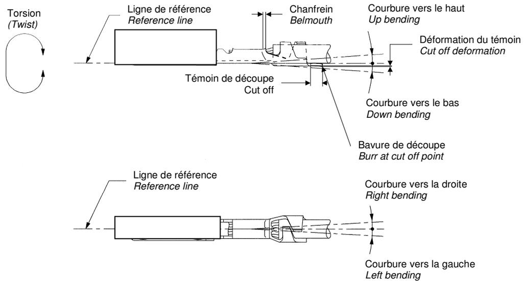
**5.7. Tenue de l'isolant au pliage**
