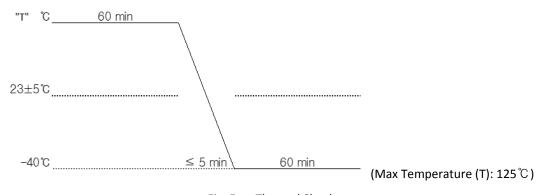
Fig. 5 Thermal Shock
