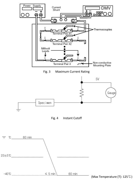
Fig. 5 Thermal Shock
