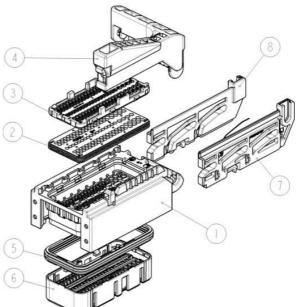
POS. 1 MAIN BODY HOUSING POS. 2 FAMILY SEAL POS. 3 HOLDER HSG FOR FAMILY SEAL POS. 4 LEVER HSG POS. 5 INNER SEAL POS. 6 CAVITY HOUSING POS. 7 SLIDE LEFT POS. 8 SLIDE RIGHT
