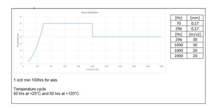
$Fig.\ 1-Vibration\ test\ diagram$
