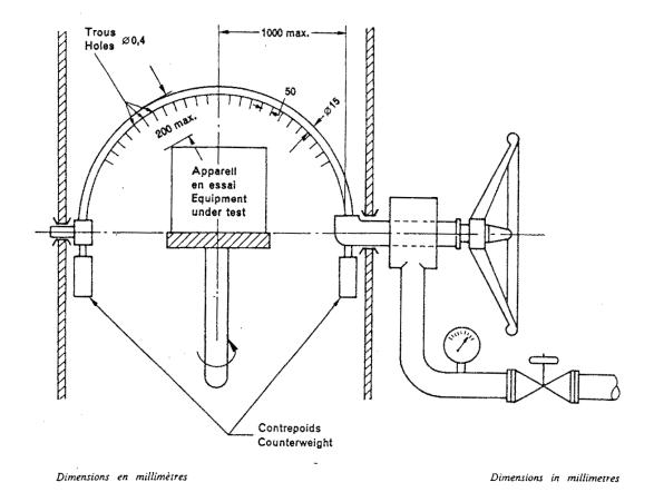
Appareil pour la vérification de la protection contre l'eau tombant en pluie et contre les projections d'eau.
