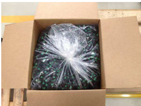
5.3 – Acomodar 2.000 peças e fechar saco plástico com cable tie PN 444316-1, conforme imagem acima.
