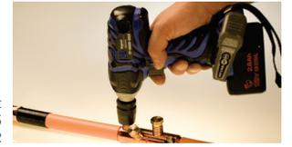
Conector de Cobre Shearbolt instalado en cable 4/0 kcmil 15 kV con aislamiento EPR
