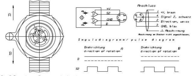
Bei D-Typen keine Ahasenverschiebung! Das Drehrichtungssignal D wird durch die Ausrichtung der Nase des Steckers beeinflusst.
