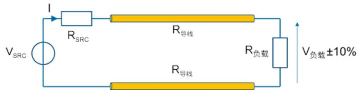
图 4: 用于电力传输的基本电路
