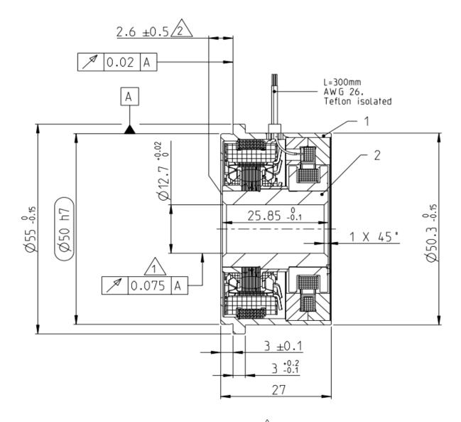
Gesamtschlag im eingebauten Zustand Concentricity in installed situation
