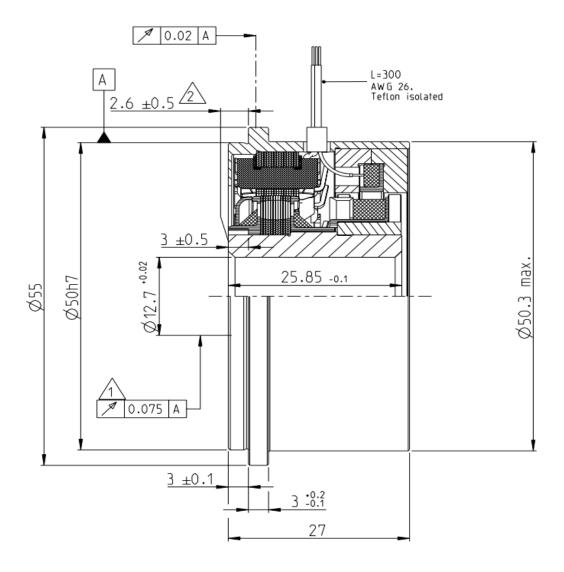
Gesamtschlag im eingebauten Zustand concentricity in installed situation
