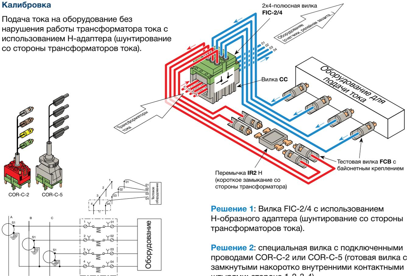
**Решение 1:** Вилка FIC-2/4 с использованием Н-образного адаптера (шунтирование со стороны трансформаторов тока).
