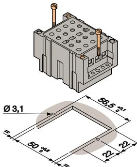
0.5 Nm < Момент затяжки < 0.8 Nm
