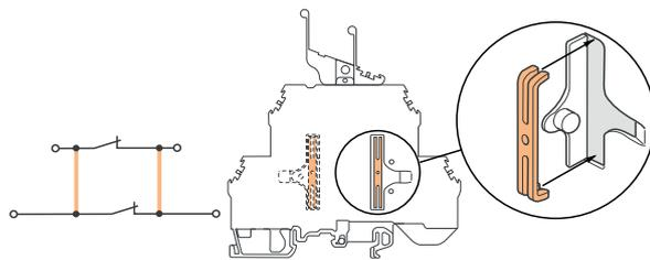
Монтаж вертикальной перемычки между уровнями (ITVE2)
