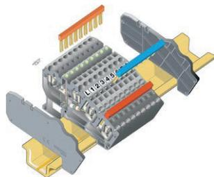
Чтобы обеспечить защиту от прикосновения (класс IP20) узла клеммных блоков с комбинированной перемычкой, необходимо установить по одному торцевому изолятору с каждой стороны узла клеммных блоков.
