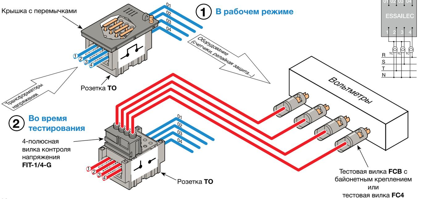
Измерение напряжения с использованием розетки для контроля напряжения типа TF (замкнутый контакт) и 4-полюсной вилки:
