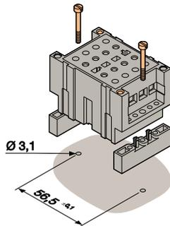
0.5 Nm < Момент затяжки < 0.8 Nm
