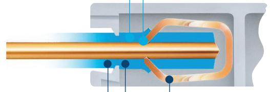
Изоляция провода зажимается изолирующим материалом.
