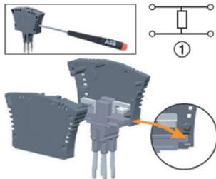
Открыть PG5-R2 плоской отверткой диаметром 3,5 мм.
