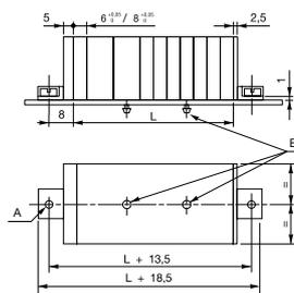
A: 2 отверстия диаметром 3.2 мм для винтов с цилиндрической головкой до 3 мм (не входят в комплект).
