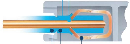
Изоляция провода зажимается изолирующим материалом клеммы.
