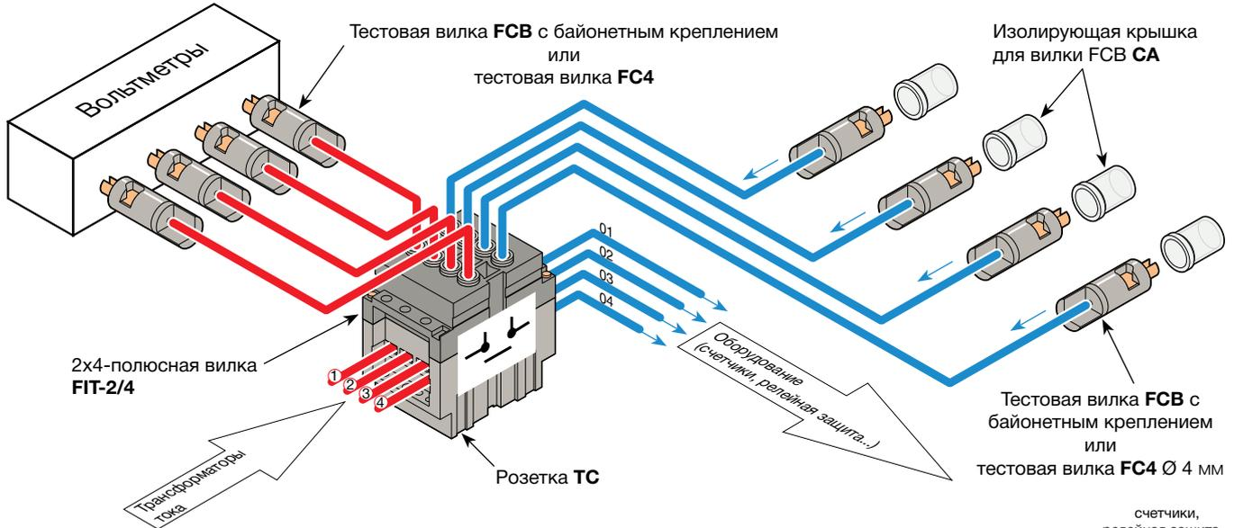
Измерение напряжения с использованием розетки для контроля напряжения типа TO (разомкнутый контакт) и 4-полюсной вилки:
