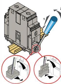
Боковое отверстие "бистабильного действия". Зажимной механизм остается в открытом или закрытом положении
