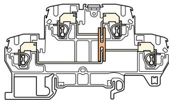
Монтаж нижней внутренней перемычки между уровнями (ITVE.L).
