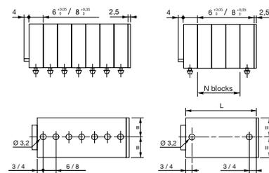
$L = (N \text{ блоков} \times 6) + (N \text{ блоков} \times 8)$
