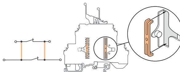
Монтаж вертикальной перемычки между уровнями (ITVE2)
