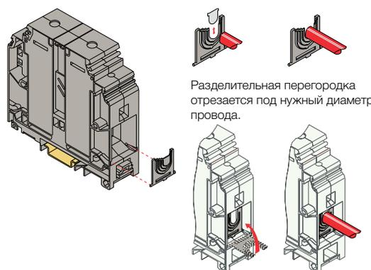
Зажимной механизм приводится в действие отверткой диам. 4 мм 0.157 in
