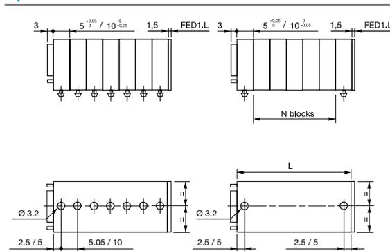
Для блоков 10 мм, устанавливать блок DH через каждые 4 блока.
