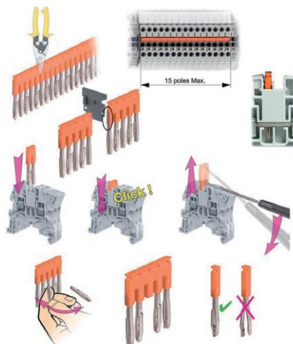
Во взрывоопасных атмосферах использование перемычек с прорезными крайними точками и прорезными промежуточными точками запрещено.
