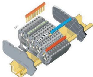
Чтобы обеспечить безопасность прикосновения (класс IP20) узла клеммных блоков с комбинированной перемычкой, необходимо установить по одному торцевому изолятору с каждой стороны узла клеммных блоков.
