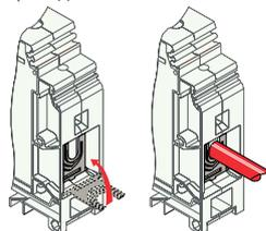
Зажимной механизм приводится в действие отверткой диам. 4 мм 0.157 in
