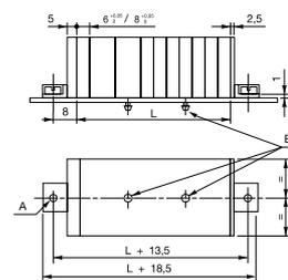
A: 2 отверстия диаметром 3.2 мм для винтов с цилиндрической головкой до 3 мм (не входят в комплект).
