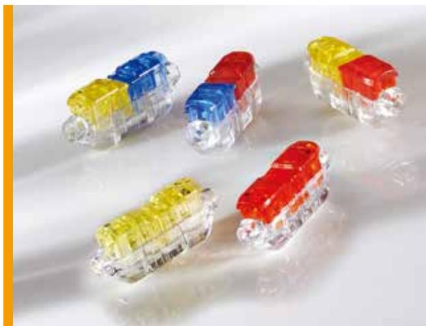
TE Connectivity (TE) 的CoolSplice系列连接器已经延展到包含大线径的使用(12AWG-18AWG)。所有CoolSplice连接器均兼容常用钳子实现按钮连接。两种导线分别进行单独连接以提高易用性,由此可对一条导线进行出厂预连接,在安装期间对另一条导线进行现场连接。所有CoolSplice连接器均有基于标准产品的注胶密封防水型产品,将CoolSplice的应用范围扩大到要求具有相应防护等级的恶劣环境应用。设计注重细节,主体材料清晰,可通过外观对连接进行检验,并可区分标准产品和防水密封型产品。红色、黄色和蓝色编码的端接按钮可标识线径,便于将不同线径与相应的连接器匹配。
